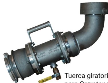
Tuerca giratoria con Rosca Hembra para Carrotanque x adaptador de desconexión en seco; espaciador de 6"; manija; purga de válvula de bola
