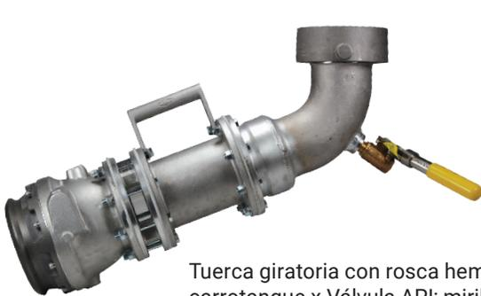
Tuerca giratoria con rosca hembra para carrotanque x Válvula API; mirilla corta; espaciador de 6"; manija; purga con válvula de bola de acción por resorte
