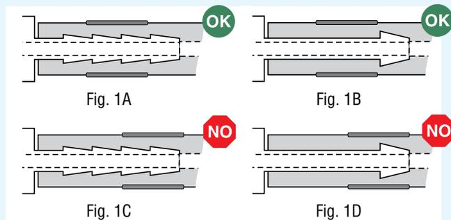
En las ilustraciones de arriba, las abrazaderas están correctamente posicionadas en la figura 1A y 1B, directamente sobre los dientes de la mitad y detrás del primer diente. Esto es extremadamente importante en el caso de acoples de un solo diente, como se muestra en la figura 1B, ya que el diente es generalmente más grande que el vástago del conector. El material comprimido no puede pasar sobre el diente cuando está bajo tensión, sujetando firmemente el conector a la manguera.
