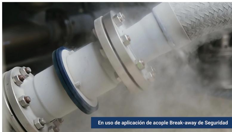
En uso de aplicación de acople Break-away de Seguridad
